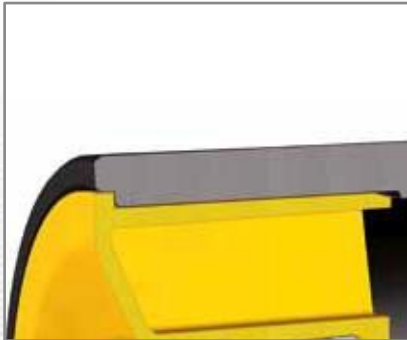
Musta HDPE-vaippa, laakeripesän ja vaipan välissä pitkä kiinnityspinta
